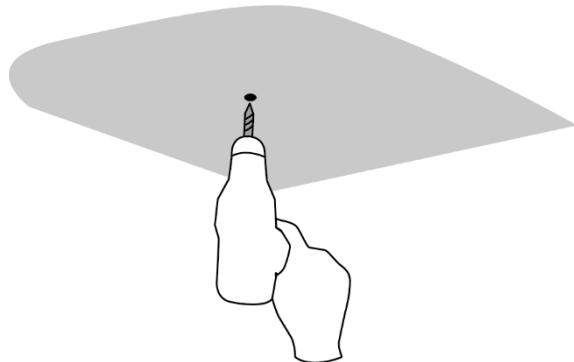
4) 穴にアンカーを埋め込み、ブラケット→ネジの順で天井に取り付けます。
