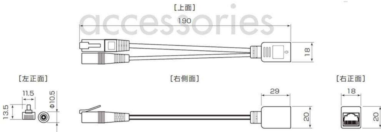
Viewla 12Vアダプター 寸法図 (単位:mm)
