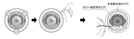
4) 2) で開けたケーブル配線用穴からケーブルを引き出しておき、STEP1の接続図を元に予め接続し、本体ベースを本体取付用ネジで固定する。
