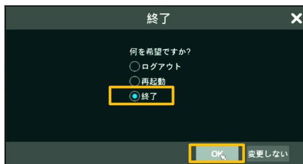
5. パスワードを入力して[OK]を押し、電源が落ちるのを待ちます。
