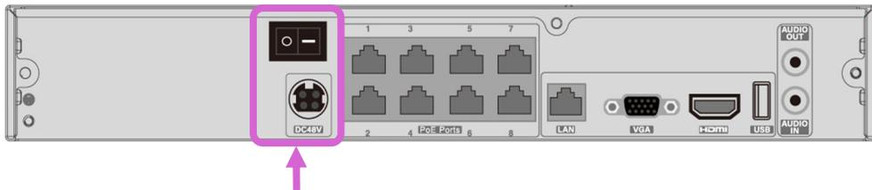
電源ケーブルを接続してから、電源スイッチを ON (—) にしてください。
