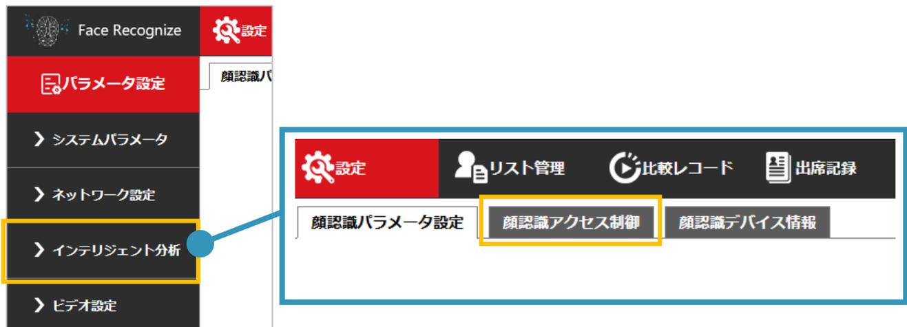
2. 中央部の<アクセス制御>内の<開始条件>で、[ホワイトリスト+ドアを開くための顔認証]を選択し、[保存]をクリックします。
