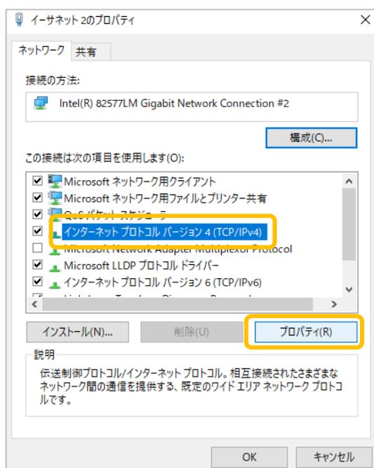
7. インターネット プロトコルバージョン 4 (TCP/IPv4)のプロパティ画面が開きます。
