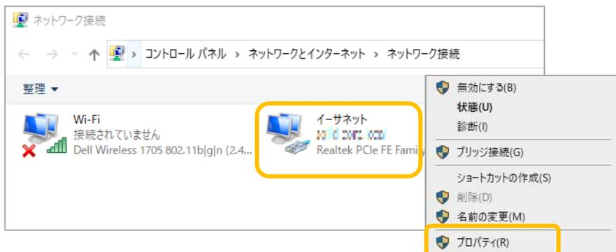
6. プロパティ画面から[インターネット プロトコルバージョン 4 (TCP/IPv4)]を選択し、右下の[プロパティ]をクリックします。
